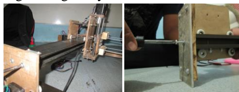
Gambar 7. Pemasangan rangkaian Y dengan XZ
