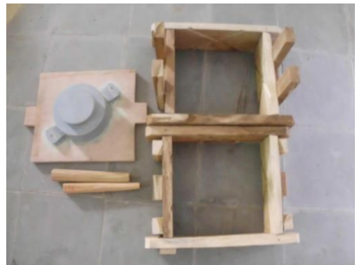
Gambar 3. Pola, rangka cetak dan saluran tuang
