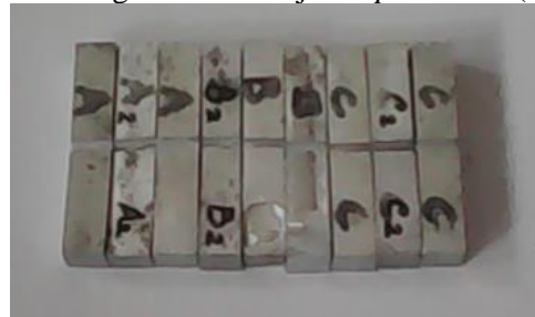
Gambar 7. Spesimen uji impak, kekerasan dan struktur mikro
