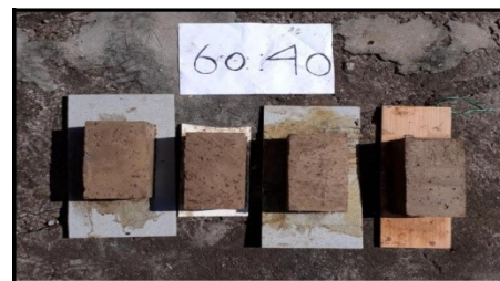
Gambar 1 Perbandingan Tailing Bauksit dan Semen PCC Paving Block
