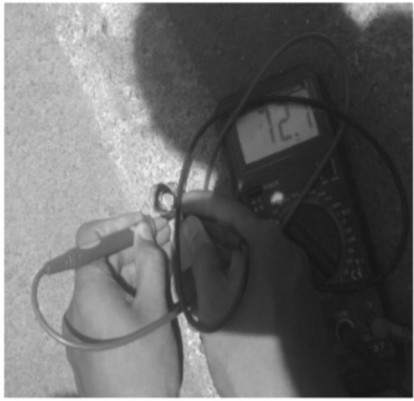
Gambar 3 Hasil tes LDR saat terang terkena sinar matahari
