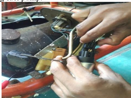
Gambar 4.2. Melepas soket fuel pump
