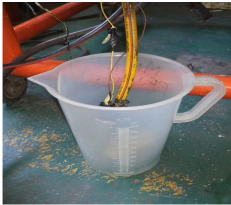
Gambar 4.6. Memasang kabel soket ke fuel pump
