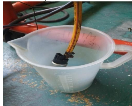
Gambar 4.5. Memasukkan fuel pump kegelas ukur
