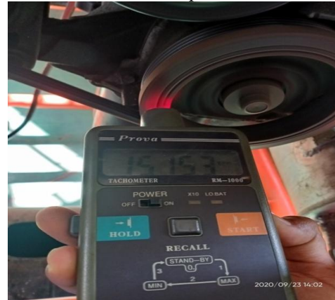
Gambar 4.8. Menyetel putaran mesin
