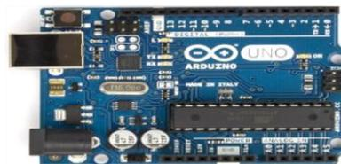
Gambar 9 Mikrokontroler AT Mega 328
