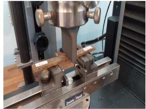
Gambar 7. Pengujian 3 Point Bend
