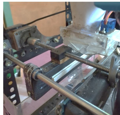
Gambar 12. Motor Stepper Penggerak Pemanas
