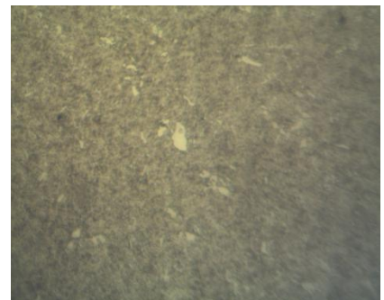
Gambar 16. Struktur SKD-11 setelah hardening holding 1 jam 20X
