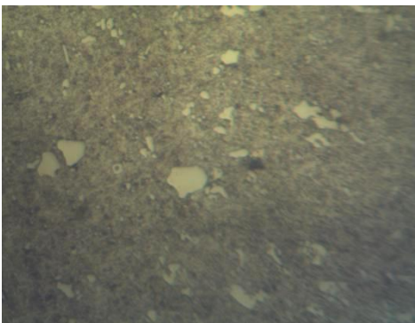
Gambar 20. Struktur SKD-11 setelah hardening holding 2 jam 50X
