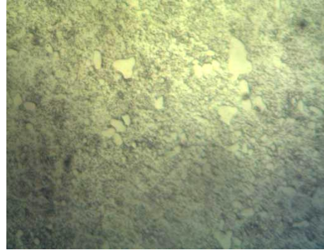
Gambar 21. Struktur SKD-11 setelah hardening holding 2 jam 100X
