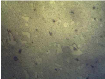
Gambar 12. Struktur dies import 100x
