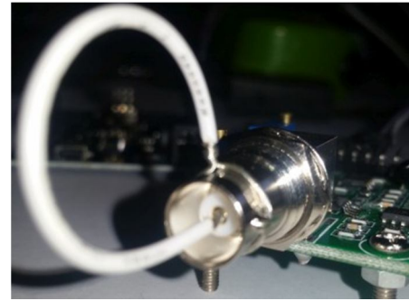
Gambar 3. Hubung Pendek Probe Konektor BNC
