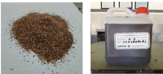
Gambar 1: Bahan Komposit (Resin BQTN dan serbuk tempurung kelapa)
