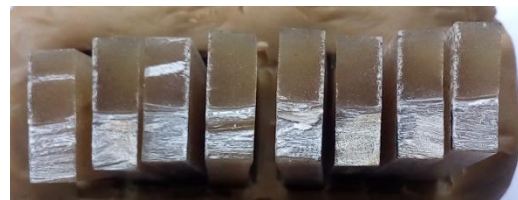
Gambar 4. Penampang patahan spesimen
