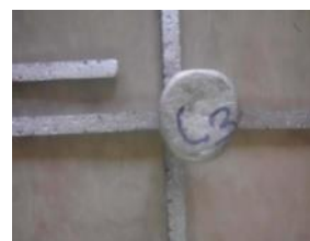
Gambar 5. Porositas benda coran
