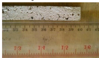
Gambar 5 Pengukuran panjang benda coran
