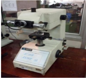
Gambar 6 Mesin Uji Kekerasan Vickers Mikro (Sumber: Lab Bahan UGM)
